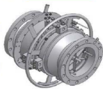
Ejemplo: Sistema de desconexión de emergencia
