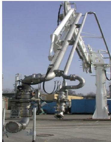
Ejemplo: Brazo de carga articulado mixto (GNL y GN) para suministro de combustible
